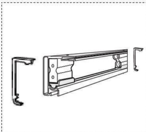
5. Corte o perfil trilho superior 4 mm menor que o vão. Após fixar o perfil nas buchas, travar todo o sistema com as cunhas que vão entre as buchas e o perfil superior.
