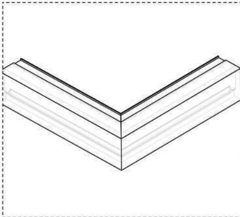
2. Observar o lado exato de cada perfil a ser cortado. O perfil guia inferior possui a peça de canto. Portanto, não é necessário cortar o perfil inferior em grau.
