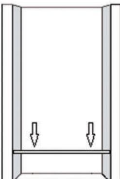
2. Corte o perfil guia na mesma medida do vão. É necessário fazer furos pequenos na parte de trás do perfil para ajudar no escoamento da água. Aparafuse e vede o perfil no chão. Encaixe o perfil com a escovinha na guia inferior.
