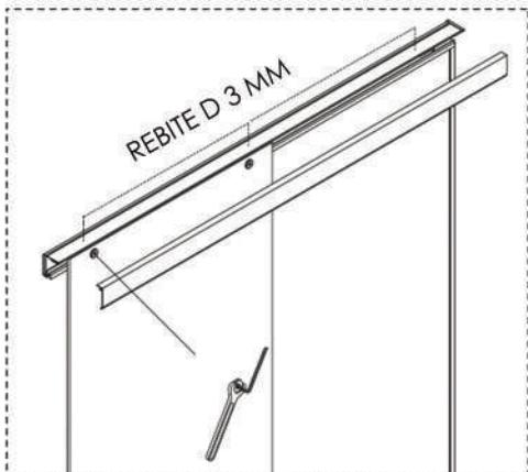
6. Monte as roldanas na porta de vidro, coloque a porta sobre a guia inferior de nylon , e a encaixe no perfil superior. Regule a porta e encaixe o perfil capa inferior.
