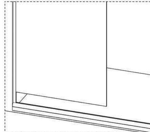
3. Corte o perfil lateral cavalinho 77 mm menor que a altura do box e aparafuse e vede na parede. Não esquecer de encaixar a fita de vedação. Coloque o vidro fixo e caso seja necessário utilize as cunhas para nivelar.
