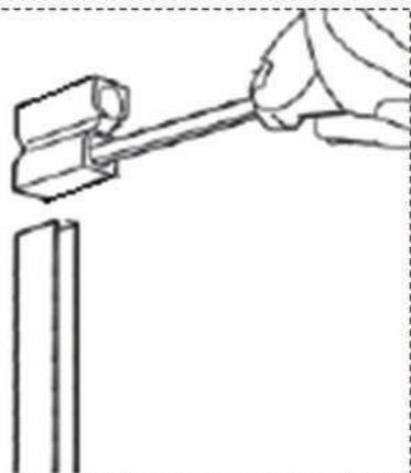
4. Marcar os furos do fixador do trilho utilizando o perfil cavalinho 11x22 mm e adicionar 20 mm para o primeiro furo e 18 mm para segundo furo.
