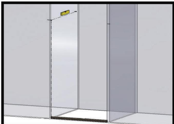
6. Montar as hastes no vidro e encaixar o vidro nos trilhos que já esta fixado na parede.
