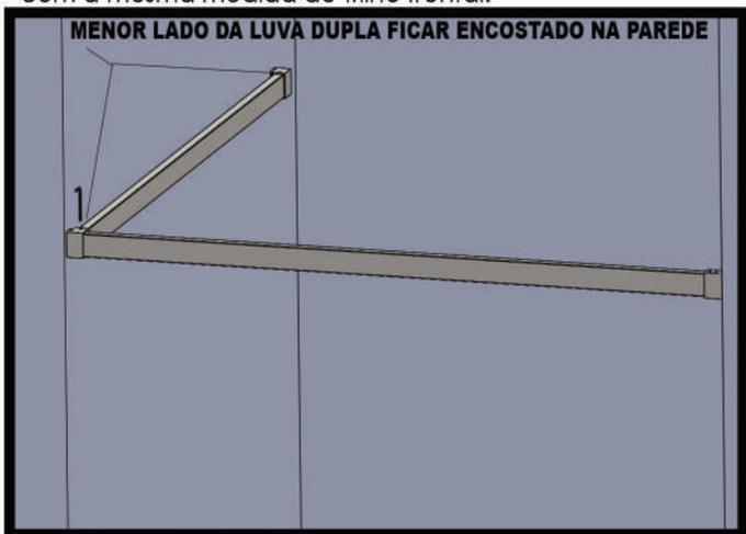
7. Coloque os perfis de vedação nas laterais do vidro e faça o furo do estaciamento conforme a imagem abaixo
