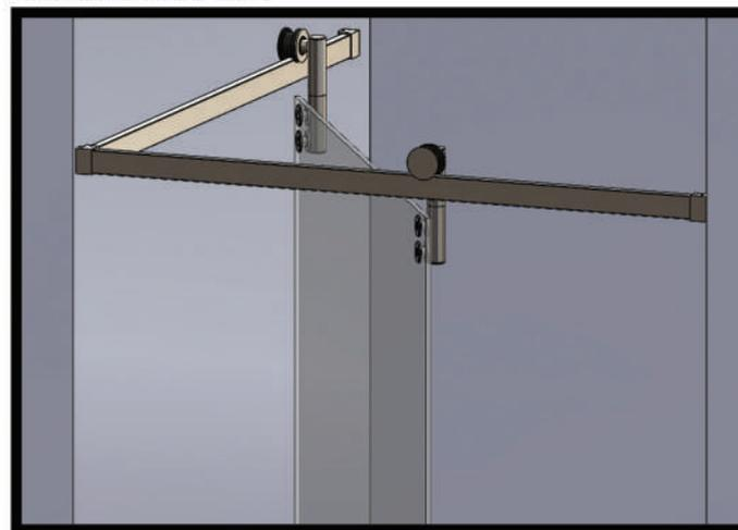
8. Para obter um deslizamento leve e perfeito o flutuador deve ficar sempre no meio da haste conforme a figura abaixo.
