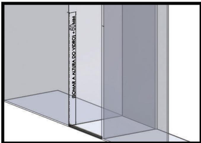
3. O furo superior está em prumo com a parte traseira do perfil capa conforme podemos observar na figura acima.
