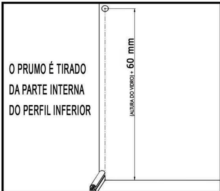
O local do furo do trilho superior tem que estar em prumo com o perfil capa inferior conforme a figura acima. Somar 60 mm na altura do vidro para encontrar o local exato do furo.
