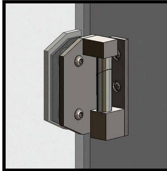
Com os dois cavaletes fixados na parede, colocar a bucha metálica no pino conforme a figura. Montar as dobradiças no vidro e encaixar o pino na bucha que esta no cavalete. Ajustar as buchas metálicas para garantir o retorno automático da porta.
