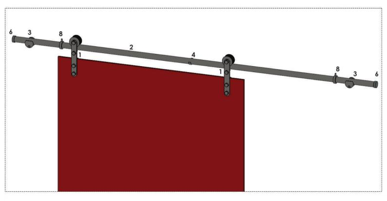
Após a instalação dos suportes na parede conforme imagem 1, cortar o trilho na medida de no mínimo duas vezes a largura do vão, não esquecer de colocar os freios superiores e as tampas laterais de acabamento no trilho. Montar as roldanas no vidro e encaixar a porta no trilho para marcar o local de instalação da guia inferior no piso, montar os puxadores da porta e regular os freios superioes.
